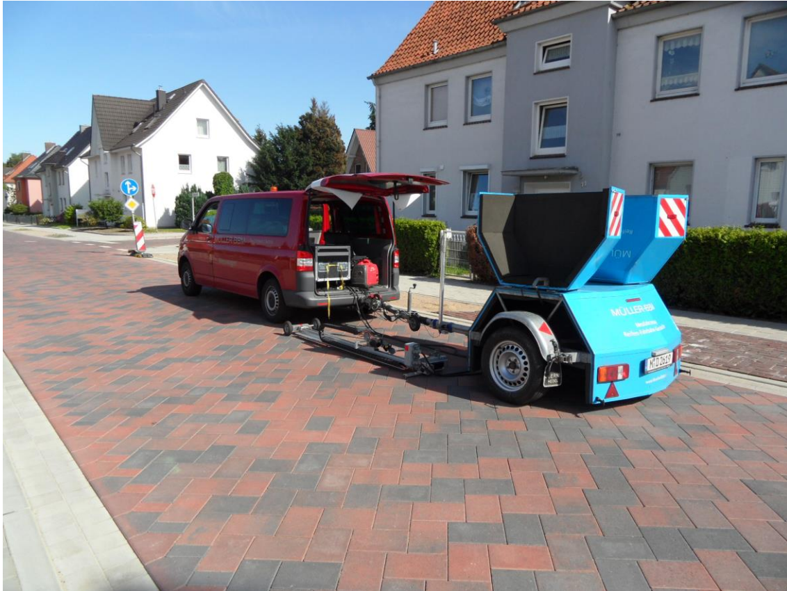
CPX-Messsystem auf einer der untersuchten Betonpflasterstrecken (Foto: Müller-BBM GmbH)
